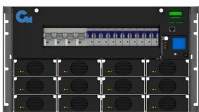
Система бесперебойного питания (СБП) типа УВС48-36 предназначена для обеспечения бесперебойной работы оборудования телекоммуникации и связи мощностью до 36 кВт. Модульная конструкция допускает установку до 12 силовых блоков мощностью 2 или 3 кВт каждый.
