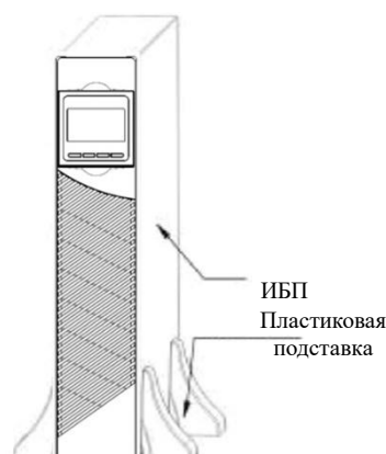
Рисунок 12. Поворот ЖК-дисплея ИБП при напольной установке.
